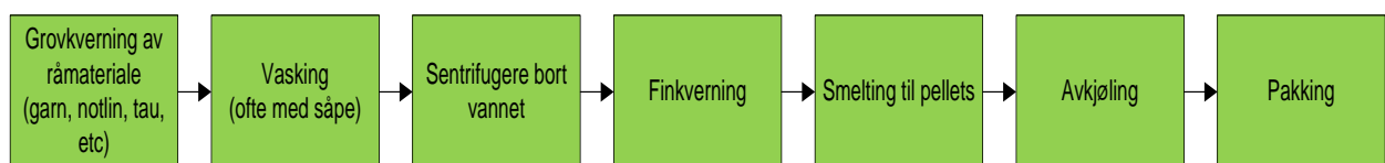
Figur 19 Verdiskapningskjeden i gjenvinningsprosessen
